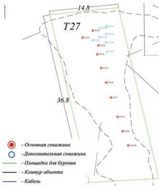
Рисунок 2.100. Схема бурения скважин на объекте T27
