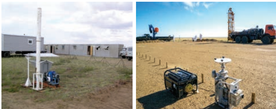
Рисунок 3.72. Отбор проб воздуха в жилой и рабочей зонах
