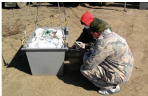
б) Измерение активности ТУК
