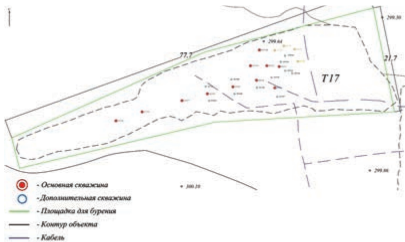
Рисунок 2.90. Схема бурения скважин на объекте Т17
