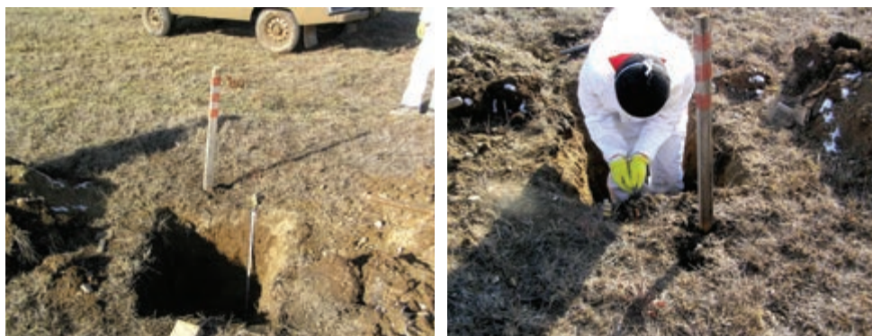
Рисунок 2.16. Послойный отбор проб почвы
