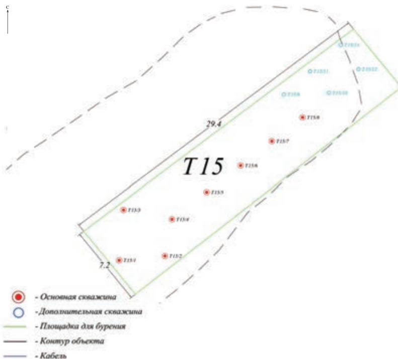
Рисунок 2.86. Схема бурения скважин на территории объекта T15
