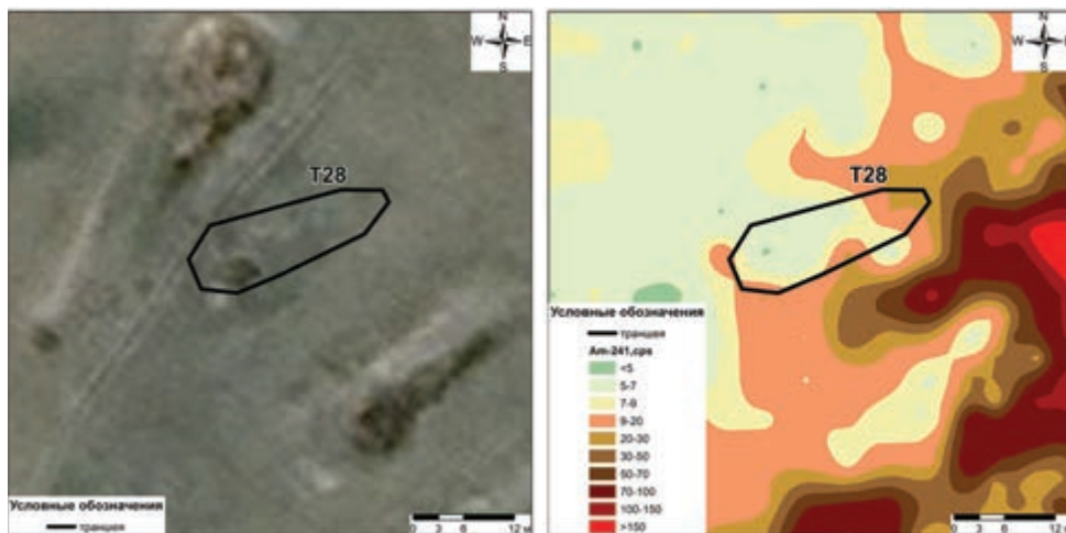
Рисунок 2.101. Космический снимок и схема площадного распределения ^{241}\text{Am} на объекте T28
