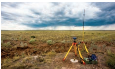
г) базовая станция EPOCH-50 в полевом лагере
