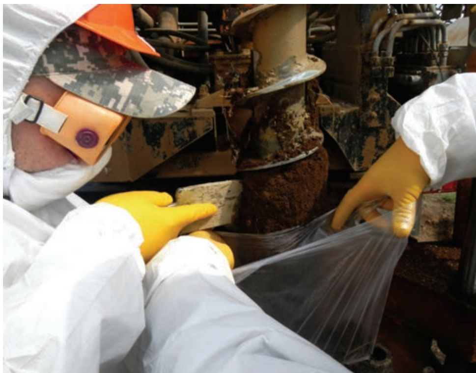
Рисунок 2.44. Отбор проб грунта с бурового шнека
