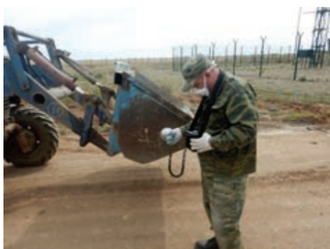
б) Радиационный контроль транспортных средств
