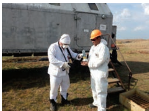
в) Радиационный контроль поверхности спецодежды персонала
