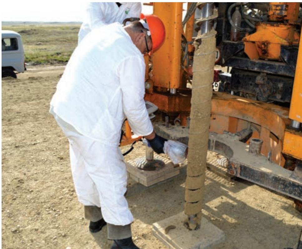
Рисунок 2.23. Измерение шнека гамма-спектрометром InSpector1000
