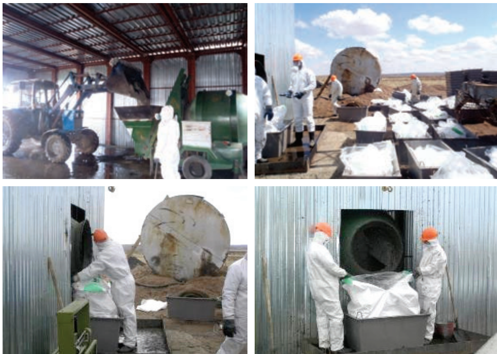
Рисунок 3.5. Бетонирование ОЯД и размещение в ТУКи
