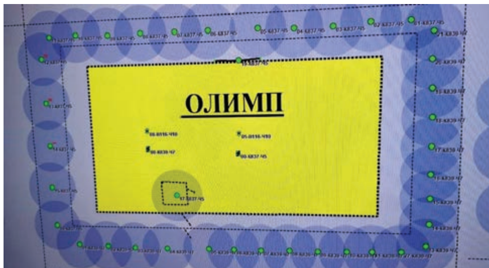
Рисунок 4.10. Отображение информации о состоянии детекторов объекта на экране системы сбора и отображения информации
