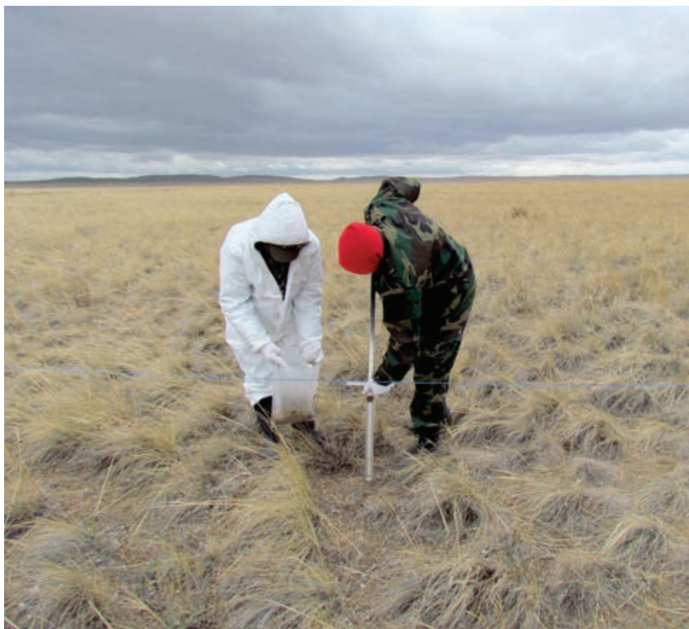
Рисунок 2.12. Отбор проб почвы для вычисления коэффициентов перехода
