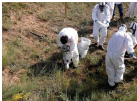
в) Контроль качества изъятия спектрометром и изъятый грунт
