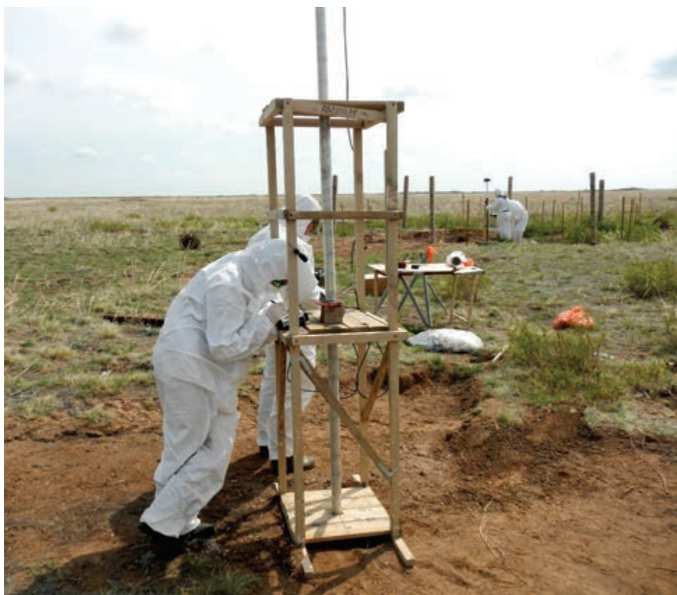
Рисунок 2.50. Проведение гамма-каротажа скважин
