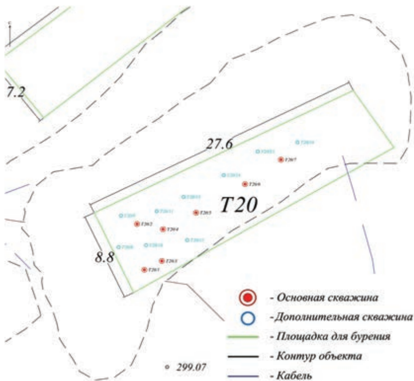
Рисунок 2.96. Схема бурения скважин на объекте T20
