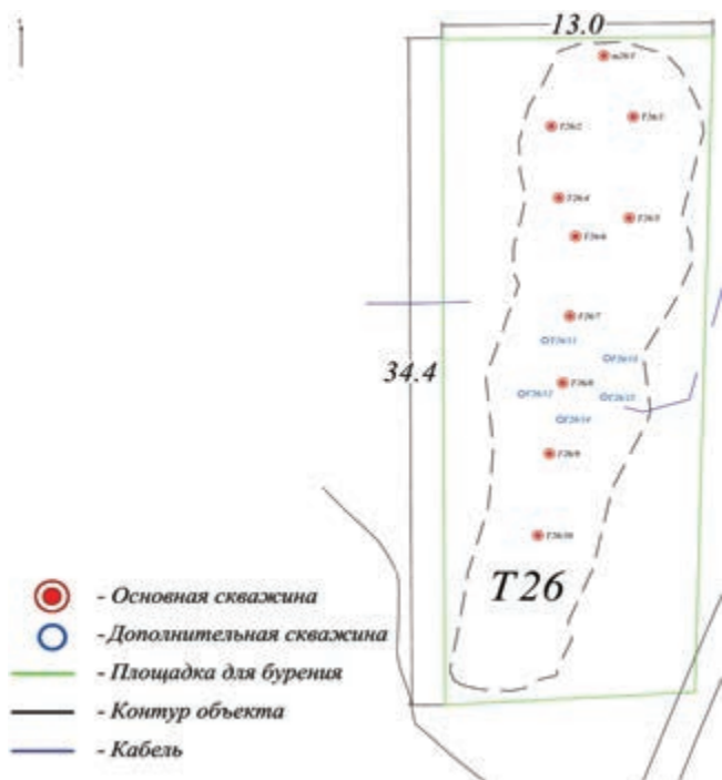
Рисунок 2.98. Схема бурения скважин на объекте T26
