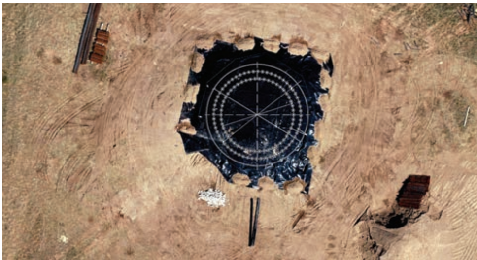
б) Снимок с наложением установленных железобетонных колонн и границами защитного сооружения
