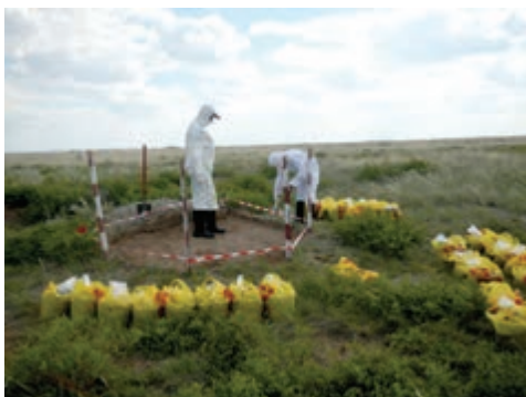
б) контроль активности грунта на участке изъятия и изъятый грунт в первичной таре
