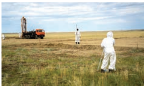
в) нивелирование площадки
