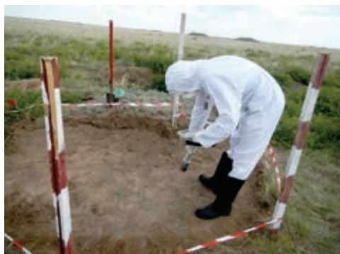
б) контроль активности грунта на участке изъятия и изъятый грунт в первичной таре
