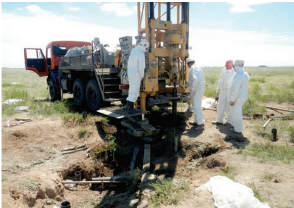
Рисунок 2.48. Бурение скважины №86 колонковым инструментом
