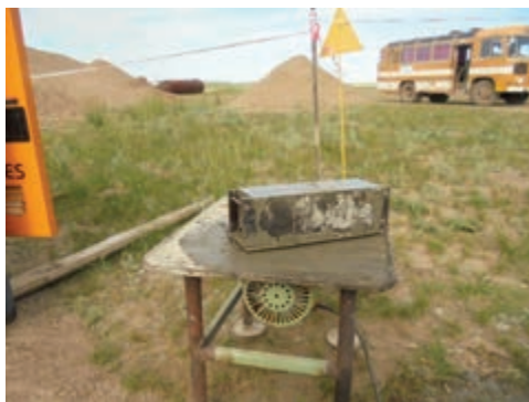
а) Вибростол для отливки образцов в лабораторию
