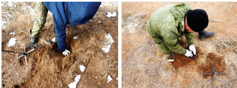
Рисунок 4.9. Установка и наладка детекторов сейсмического принципа действия
