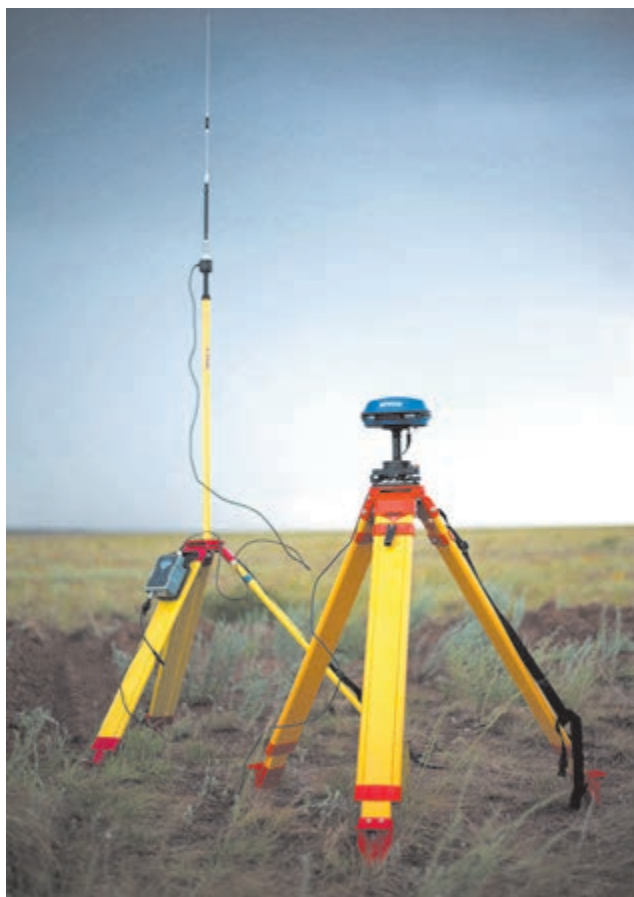
Рисунок 2.18. Базовая станция EPOCH-50 в полевом лагере
