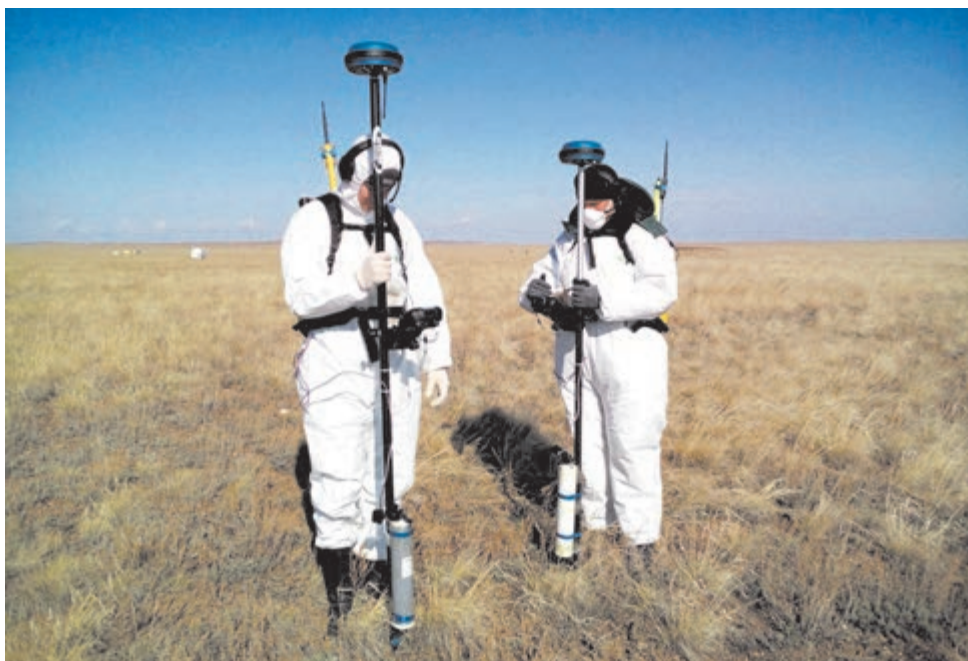
Рисунок 2.13. Гамма-спектрометрические измерения по сети 0,5x0,5 м
