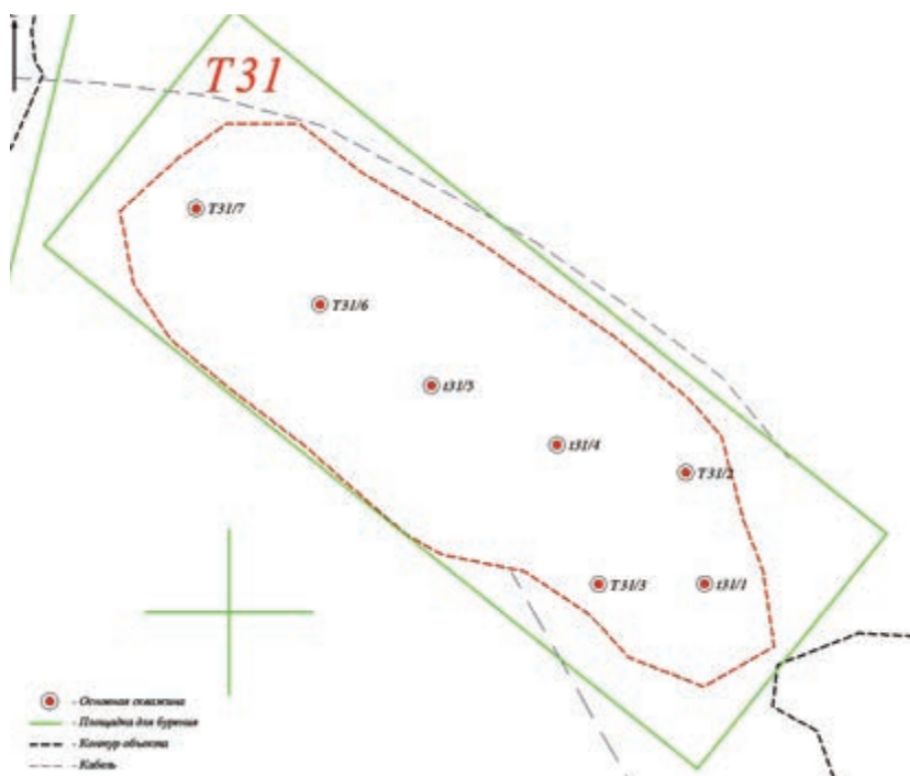
Рисунок 2.19. Объект Т-31. Контур площадки для бурения скважин
