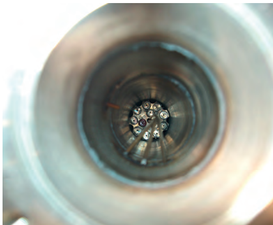
б) ТВС внутри трубы из нержавеющей стали
