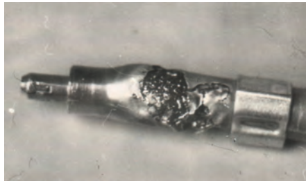
а) следы эвтектического взаимодействия нержавеющей стали дистанционирующей решетки и сплава Э-110 отсутствуют (низкоплавкая эвтектика не образуется) при охлаждении нетермометрированного твэла водой, несмотря на очевидно высокую контактную температуру (рядом с фрагментом решетки имеется прогар, заполненный расплавом), ориентировочная температура оболочки более 1350 К, температура топлива не более 2900 К (оценка по измерениям термометрированного твэла), начальное давление под оболочкой 2,5 МПа, «вспышка», вода, 96Ф-9
