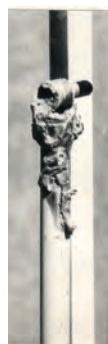
г) нижняя заглушка твэла и затвердевший расплав на верхнем торце штанги, фиксирующей нижний конец твэла
