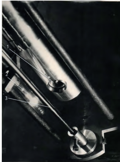
1 – входное окно; 2 – лампа подсветки; 3 – модельный твэл Рисунок 27 – Головная часть технического эндоскопа
