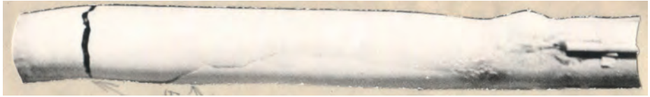
а) глубоко окисленная оболочка твэла до ее разрушения на отдельные фрагменты
