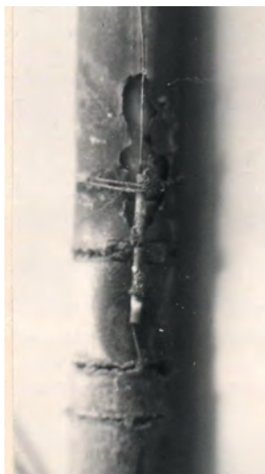
а) разрушение оболочки в местах ее контакта с защитным чехлом термопары и родиевыми бандажами
