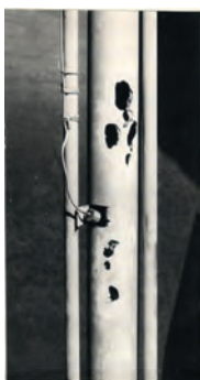
а) труба, внутри которой был установлен твэл, поврежденная фрагментами расплава
