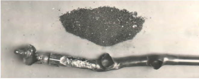
Рисунок 25 - Общий вид оболочки твэла и фрагментированного топлива. Энергичное взаимодействие с водой, ударная волна, начальное давление под оболочкой 2,5 МПа, «вспышка», вода, 96Ф-22 (нетермометрированный твэл)
