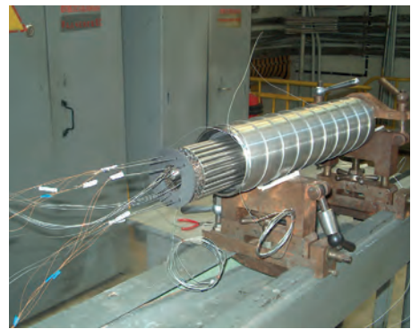
Установка ТВС в чехол камеры плавления
