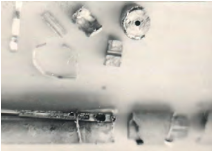
а) хрупкое разрушение топливных таблеток на крупные фрагменты.
