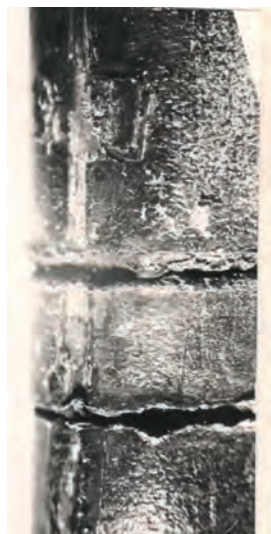
б) сквозные прогары оболочки в местах установки родиевых бандажей
