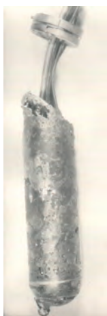
а) слиток свинца с твэлами после извлечения из ампулы
