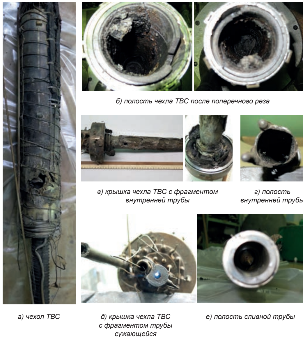
Рисунок 1.66. Внешний вид чехла ТВС после выполнения резов № 1 и № 2
