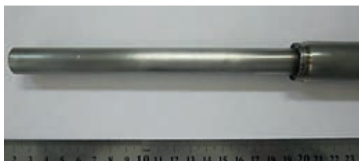
а) сварное соединение активной ячейки с корпусом АУ
