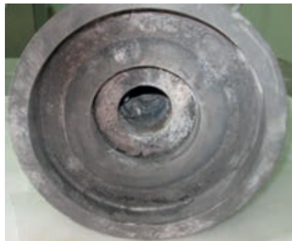
Рисунок 1.28. Слиток расплава в верхней ловушке (вид снизу)
