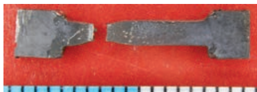
д) образец P-1_1.4, T=470 °C; t=100 ч
