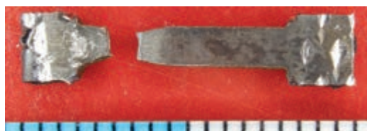
в) образец P-1_1.2, T=470 °C; t=10 ч
