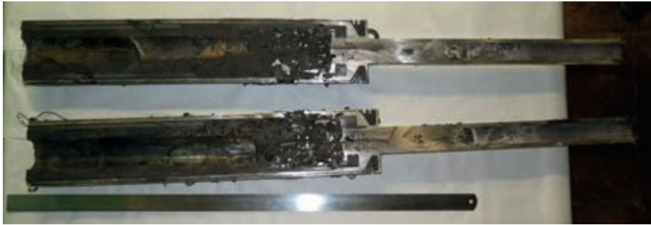
Рисунок 1.67. Внешний вид чехла ТВС после продольного реза № 3
