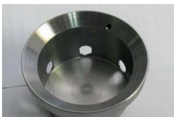
а) верхняя часть устройства задания расхода натрия (вид сверху)
