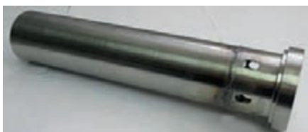
в) устройство задания расхода натрия после сварки
