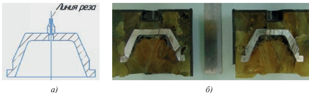
Рисунок 1.75. Схема реза (а) и внешний вид после разделки отбойника трубы расширительной (б)
