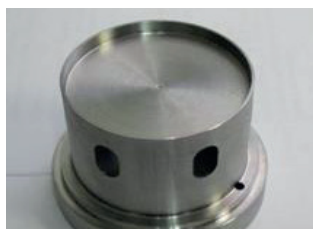
б) верхняя часть устройства задания расхода натрия (вид снизу)
