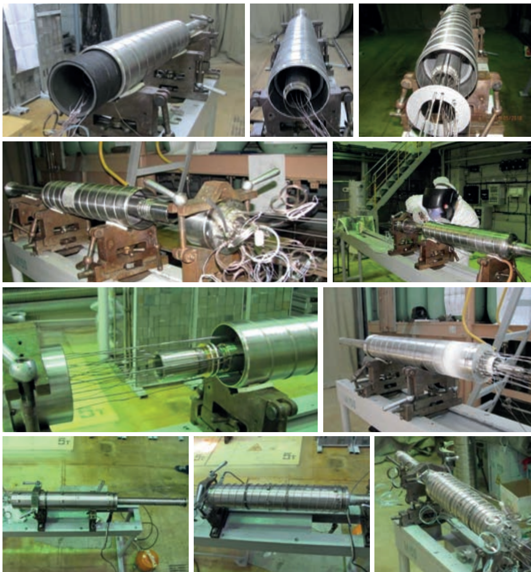
б) процесс сборки чехла ТВС
