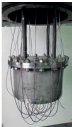
Рисунок 1.14. Внешний вид вновь изготовленной емкости приема расплава
