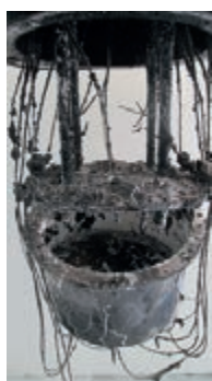
Рисунок 1.12. Емкость приема расплава после извлечения из нижней ловушки
