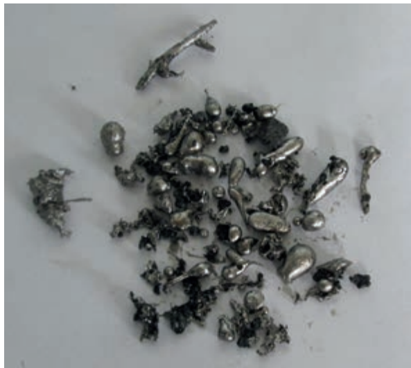
Рисунок 1.29. Расплав, извлеченный из корзины нижней ловушки
