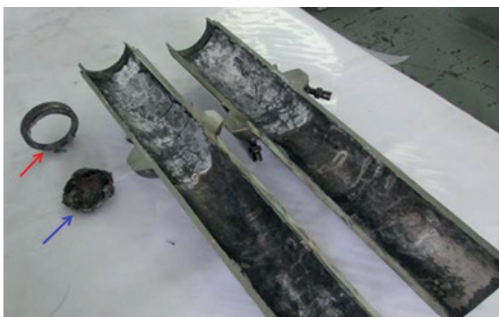
Рисунок 1.21. Сливная труба после разрезки (стрелками показаны кольцо верхней торцевой части и дно расходозадающего устройства)
