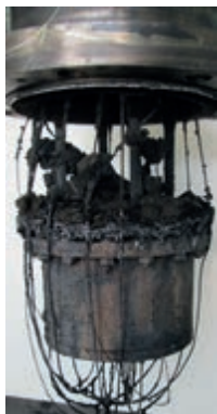
Рисунок 1.17. Внешний вид емкости приема расплава после эксперимента
