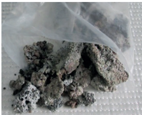
Рисунок 1.34. Расплав, извлеченный из корзины нижней ловушки
