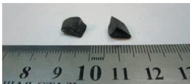
Рисунок 3.15. Фотография лития перед загрузкой в АУ
