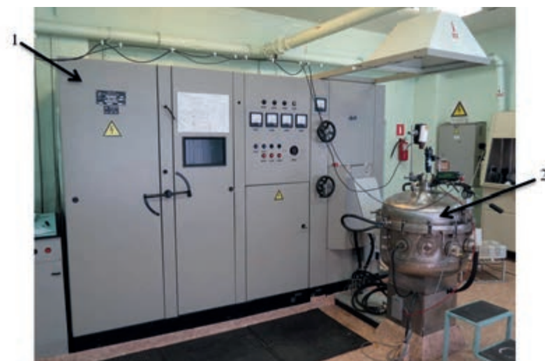
1 – генератор ВЧГ1-60/0,066, 2 – водоохлаждаемая рабочая камера
