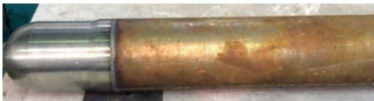
б) ловушка расплава приварена к лайнеру
