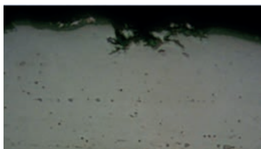
в) ОТВС 71517003188 (№ 7) после испытаний при напряжении 0,5 \cdot \sigma_T
