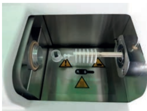
Рисунок 6.11. Реакционная камера ТГ-анализатора с исследуемым образцом
