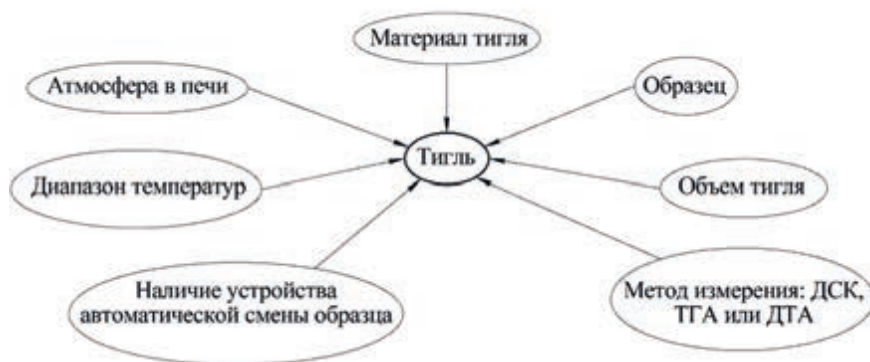
Рисунок 6.8. Факторы, влияющие на выбор тигля для измерений ТГ-анализатором TGA/DSC 3+
