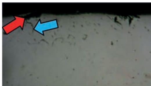
а) ОТВС Ц-1 (№ 6) после испытаний при напряжении 0,5 \cdot \sigma_T
