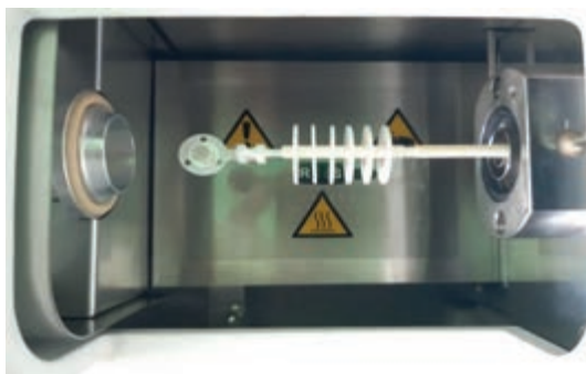
Рисунок 6.19. Образцы индия, загруженные в тигель, установленный на подложке керамического TGA SDTA сенсора модуля TGA/DSC 3+ перед калибровкой
