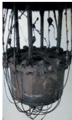
Рисунок 1.18. Внешний вид емкости приема расплава после удаления имитатора кориума с крышки
