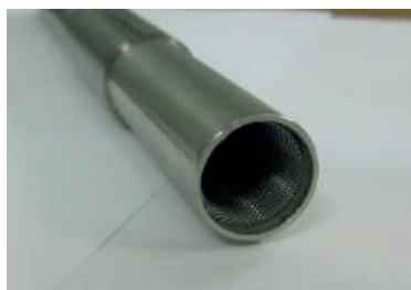
Рисунок 3.13. Размещение матрицы КПС в экспериментальной ячейке АУ
