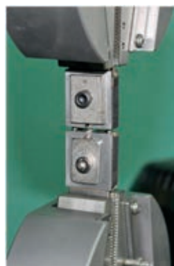
б) фиксация захватного приспособления в испытательной машине
