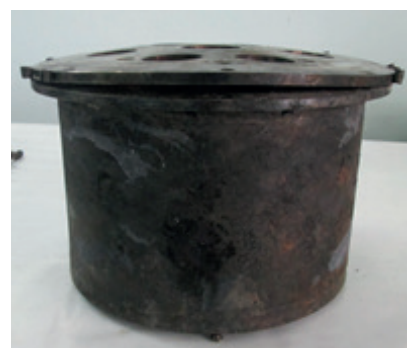
Рисунок 1.13. Емкость приема расплава после отмывки от натрия
