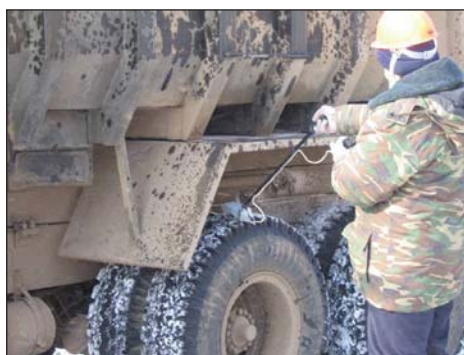
Измерение загрязнения поверхностей техники на припортальном участке
