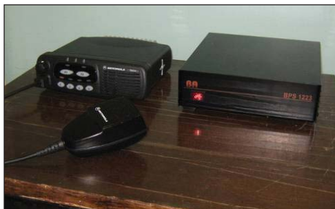
Рисунок 3.242. Радиостанция GM-340 с блоком питания, установленная в НЯЦРК
