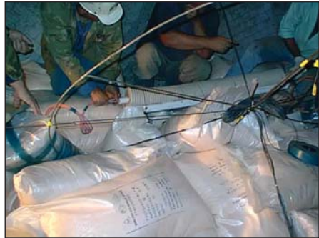
Рисунок 2.16. Вид камеры взрыва с измерительными датчиками, боевиками и шаблоном
