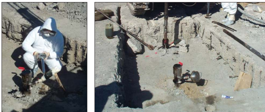
Рисунок 3.69. Выпуск из контейнера загрязненного воздуха
