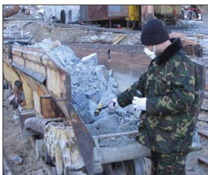
Измерение загрязнения поверхностей техники на припортальном участке
