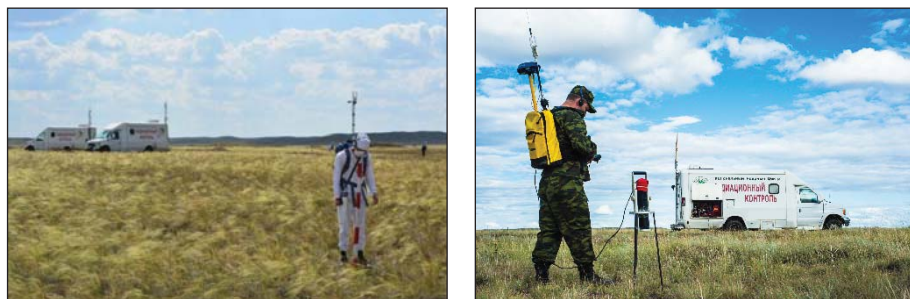
Рисунок 3.218. Проведение пешеходной гамма-съемки на «Опытном поле»
