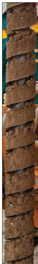
Рисунок 3.225. Общая схема послойного отбора проб почвы при проведении буровых работ в котлованах (траншеях) и вид шнека
