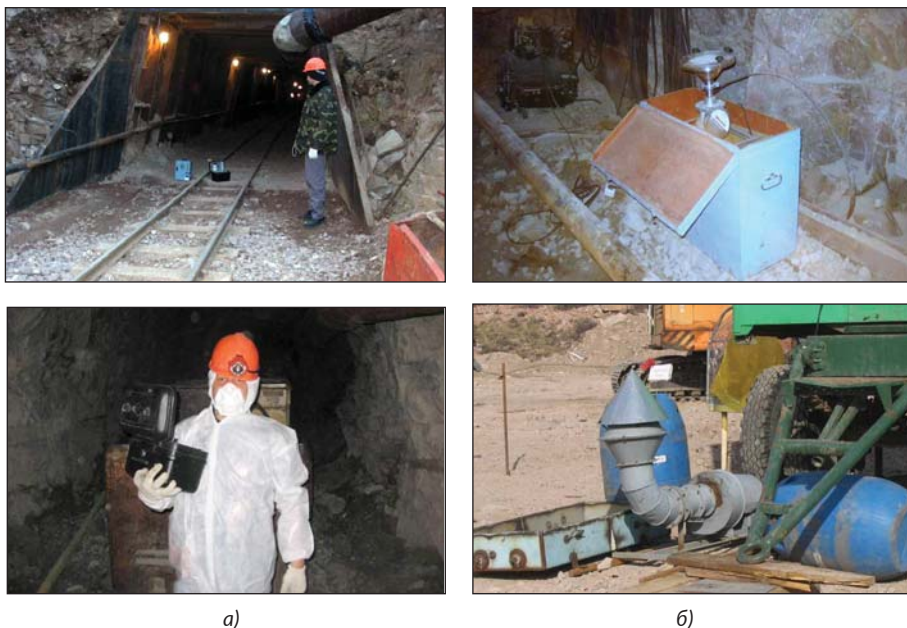
Рисунок 3.146. Измерение ЭРОА радона и торона в сооружении (а) и отбор проб воздуха рабочих зон (б)
