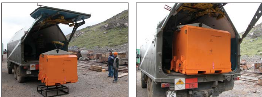
Рисунок 3.158. Сдача контейнера на перевозку и загрузка транспортного контейнера в спецавтомобиль
