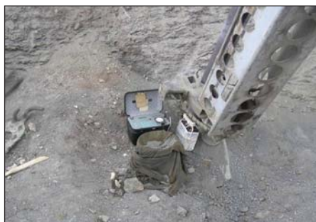
Рисунок 3.181. Измерение ЭРОА радона и торона на рабочей площадке
