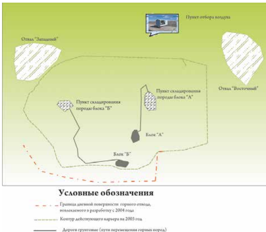
Рисунок 5.16. Схема расположения и складирования горных пород блоков А и Б
