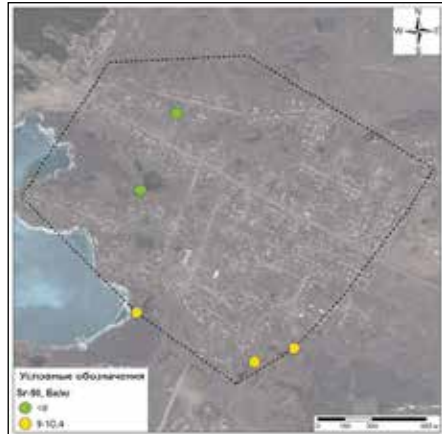
Рисунок 3.11. Содержание ^{90}\text{Sr} в почве в отдельных точках по результатам радиохимического анализа и отношение удельных активностей ^{90}\text{Sr}/^{137}\text{C}
