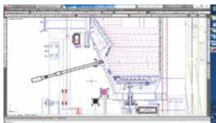
Рисунок 2.61. Размещение системы визуализации диверторной области в прямом патрубке dy80
