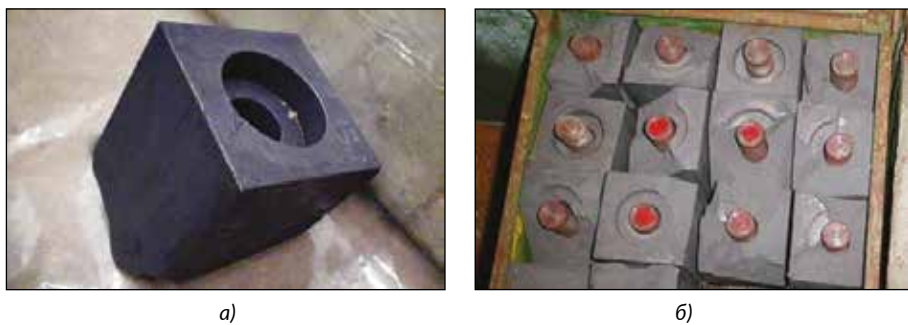
Рисунок 2.11. Трещины (а) и сколы (б) на поверхностях топливных блока из контейнера №4
