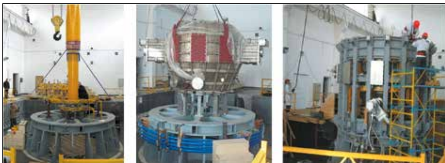
Рисунок 1.42. Процесс монтажа токамака КТМ
