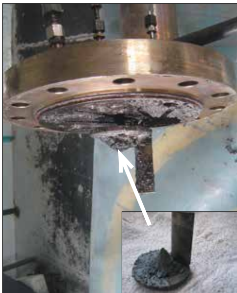
Рисунок 4.65. Крышка ловушки расплава с расплавом на защитном экране
