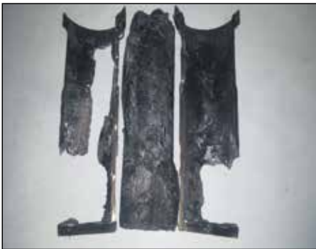
Рисунок 4.81. Вид регулятора расхода натрия со слитком расплава после разреза.
