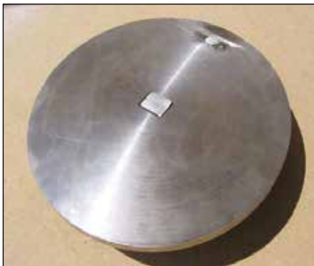
в) фронтальная сторона варианта узла для образца с поверхностью размером 15x20 мм
