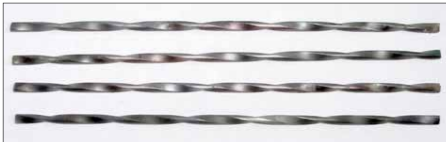
Рисунок 2.36. Внешний вид штатных твэлов ЯРД
