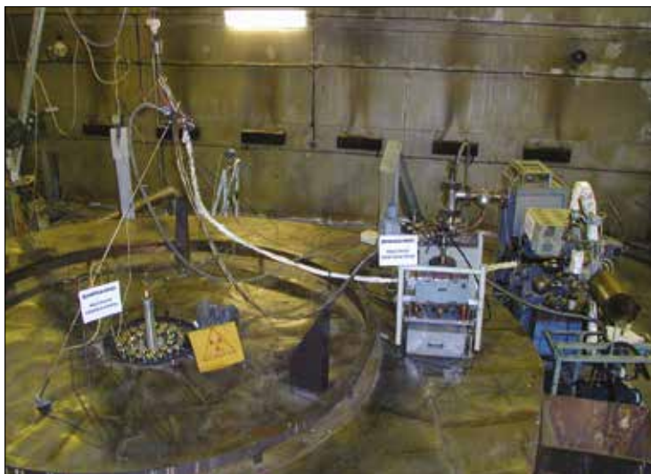
Рисунок 5.69. Размещение стенда ЛИАНА в реакторном зале реактора ИВГ.1М
