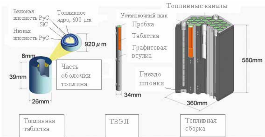
Рисунок 3.57. Компановка активной зоны реактора KHTR
