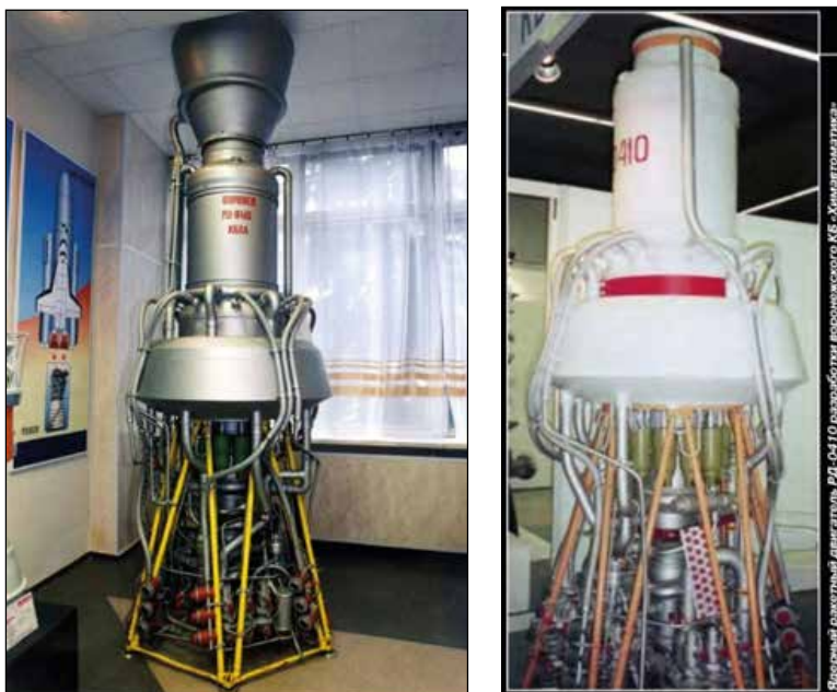
Рисунок 3.38. Ядерный ракетный двигатель РД-0410 (по другой системе обозначений 11Б91), который мог бы совершить своей первый космический полет примерно в 1985 году
