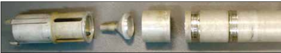
Рисунок 5.10. Фрагменты головки канала (вырезаны и отсутствуют на снимке фрагменты, содержащие сварные швы №1 и №2 пенала головки)
