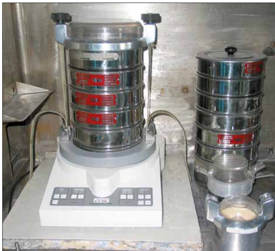
Рисунок 1.17. Установка для автоматического просеивания частиц затвердевшего кориума
