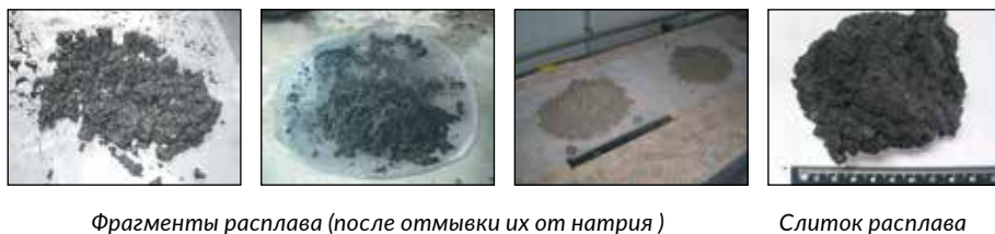
Рисунок 4.63. Фрагменты расплава окиси алюминия после взаимодействия с жидким натрием
