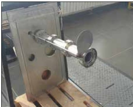
Рисунок 2.55. Смотровой вакуумный патрубок для размещения оптоволоконного световода и объектива системы визуализации
