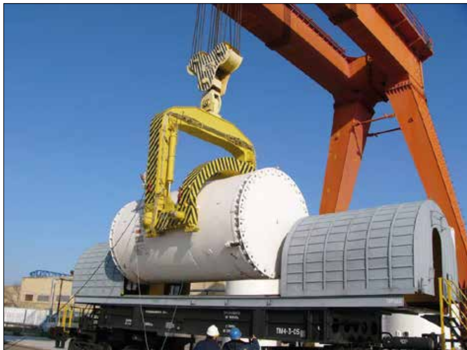
Рисунок 2.19. Погрузка ТУК-123 на ж/д транспортер ТМ 4-3 с помощью козлового крана на площадке временного хранения (ТОО «МАЭК-Казатомпром»)
