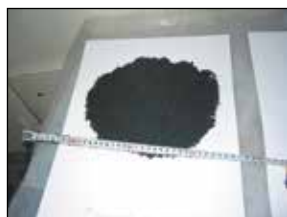
Рисунок 4.71. Расплав после отмывки сухим и влажным паром
