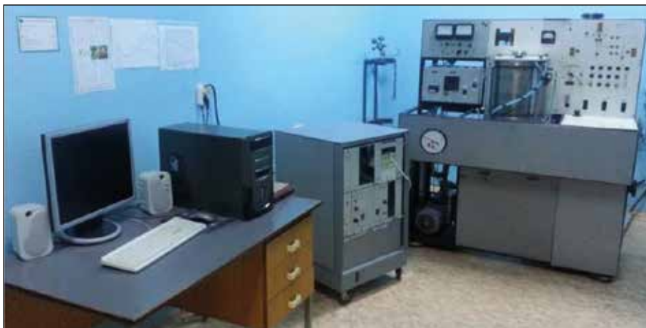
Рисунок 1.13. Установка для определения теплофизических свойств УТФИ-2
