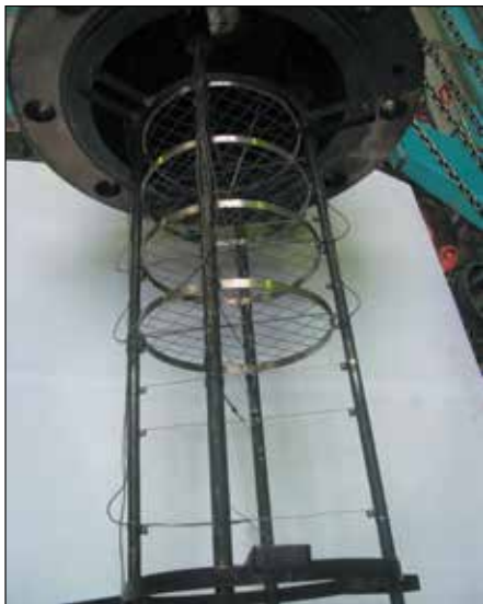
Рисунок 4.73. Общий вид устройства со средствами измерений, индикаторными проволочками и индикаторными сетками
