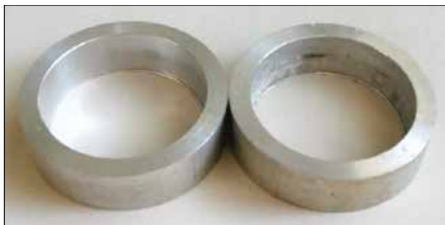
Рисунок 5.13. Фрагменты пенала головки, содержащие шов №1 до (слева) и после (справа) эксплуатации в реакторе
