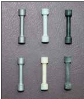
серое оксидное покрытие белое эмталиевое покрытие черное оксидное покрытие
