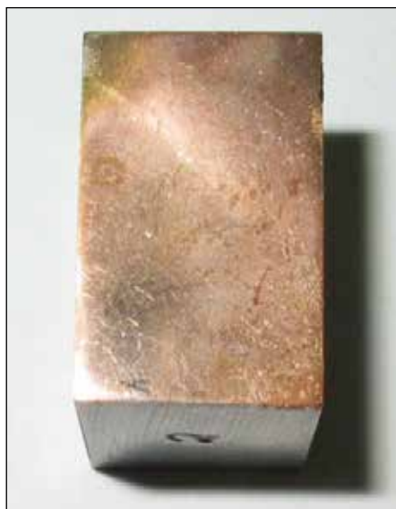
Рисунок 5.43. Напыленная медью облученная поверхность бериллиевого образца
