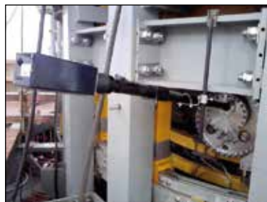
Рисунок 2.59. Размещения системы визуализации диверторной области в патрубке dy\ 320
