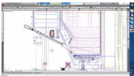
Рисунок 2.60. Размещение системы визуализации диверторной области в наклонном патрубке dy80
