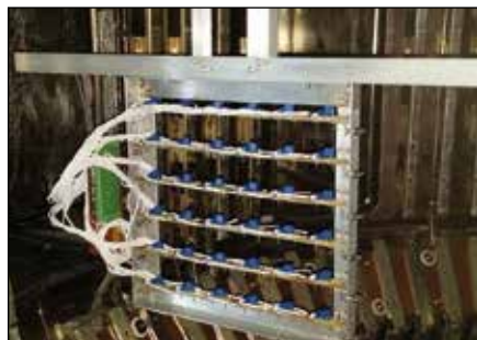
б) фотография матрицы датчиков Холла внутри ВК КТМ
