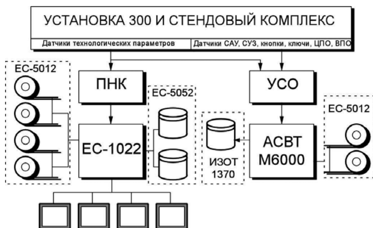
Рисунок 3.42. Структура ИИС РУ ИВГ.1М (1978 год)
