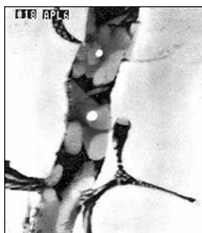
тонкая структура прослойки в трещине ( \times 6000 )
