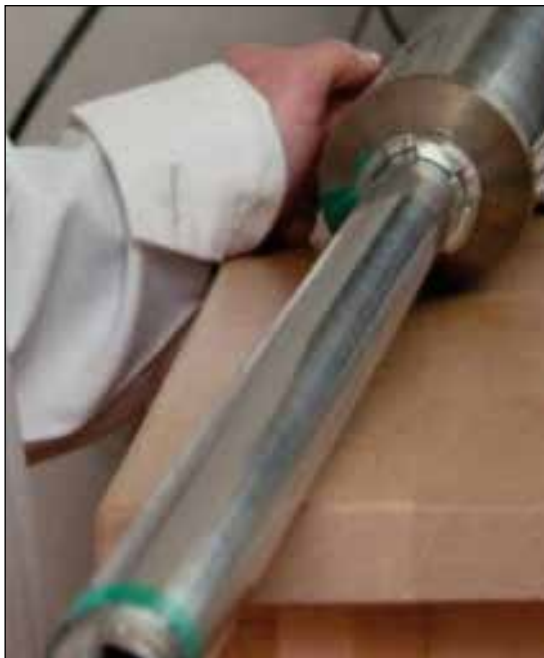
Рисунок 3.19. Конвертер тепловых нейтронов в нейтроны с энергией 14 МэВ, сконструированный на реакторе MARIA
