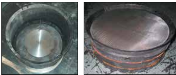
Рисунок 4.61. Сетки фильтра-ловушки расплава и ловушка в сборе
