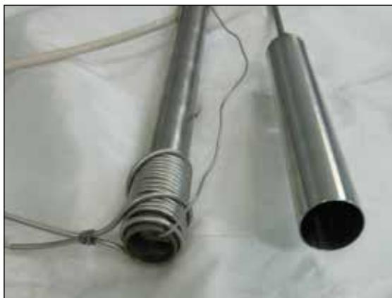
в) нижняя часть АУ с нагревателем и кожухом охлаждения
