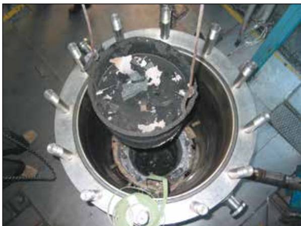
Рисунок 4.70. Смесь расплава с натрием в ловушке расплава
