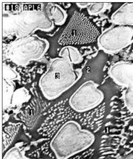
тонкая структура многофазной области ( \times 1800 )
