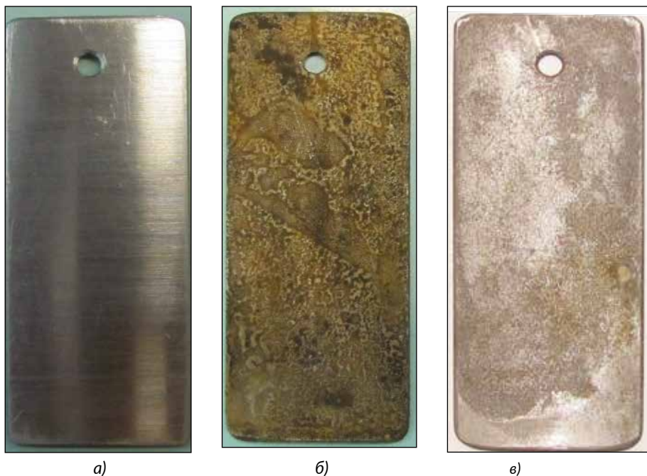
Рисунок 5.34. Образец-свидетель в исходном состоянии (а), после коррозионных испытаний (б) длительностью 420 суток и после стравливания поврежденного коррозией слоя (в)
