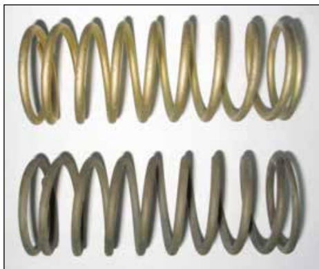
Рисунок 5.29. Состояние пружины до (вверху) и после (внизу) 100-часовых испытаний
