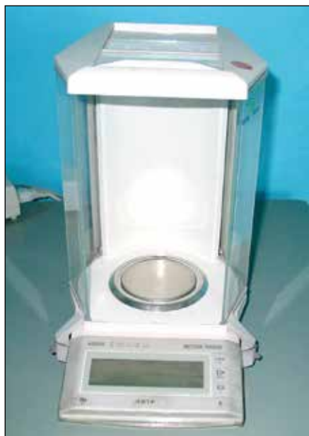
а) Лабораторные аналитические весы б) Электронные весы ВЛ Э134 «METTLER-TOLEDO» AG204 (0,1мг)
