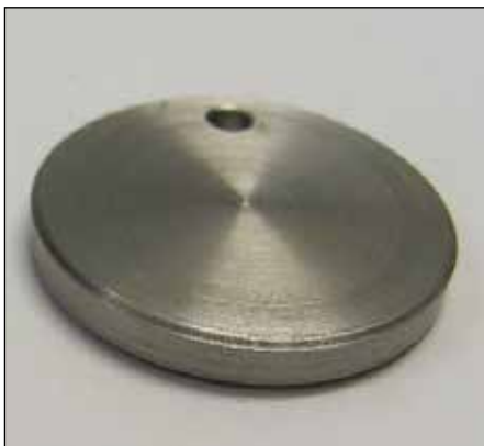
Рисунок 5.36. Внешний вид образца-свидетеля новой (дисковой) формы
