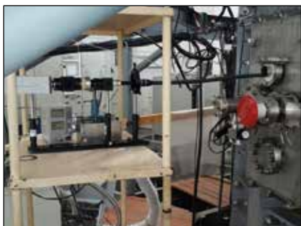
Рисунок 2.56. Система визуализации, смонтированная на вакуумной камере токамака КТМ
