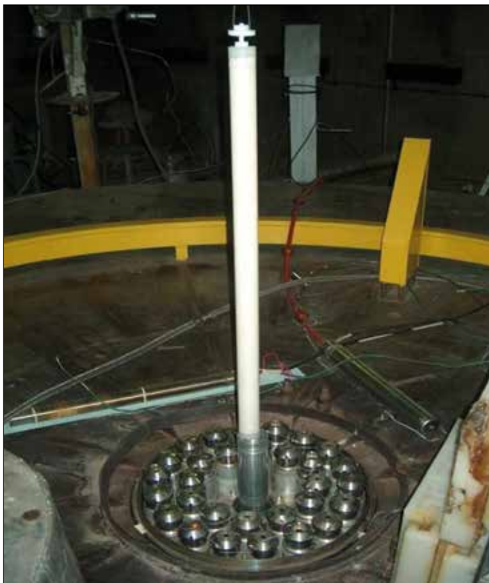
Рисунок 3.11. Загрузка облучательного устройства в экспериментальный канал реактора ИВГ.1М
