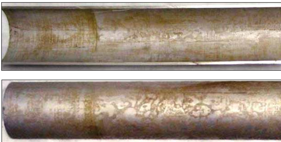
Рисунок 5.19. Внутренняя поверхность фрагмента корпуса канала в месте расположения ТВС (вверху) и внешняя поверхность фрагмента втулки ТВС (внизу)
