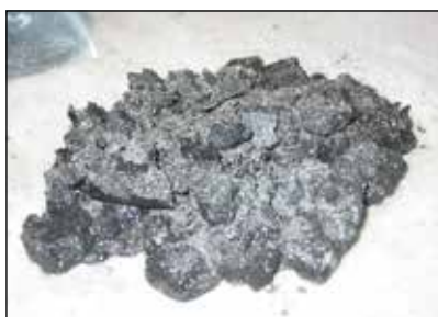
Рисунок 4.66. Фрагменты расплава, извлеченные из ловушки расплава
