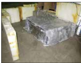
б) монохроматор и оптический спектрометр в защитном коробе из кадмия и свинца
