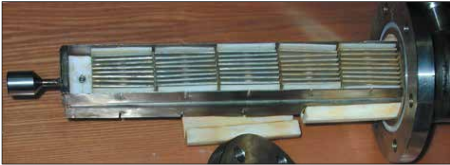
Рисунок 5.1. Канал КВК-300 в момент начала разборки (внутри частично выдвинутой кассеты видны пять блоков образцов-свидетелей из сплава АМг6М)
