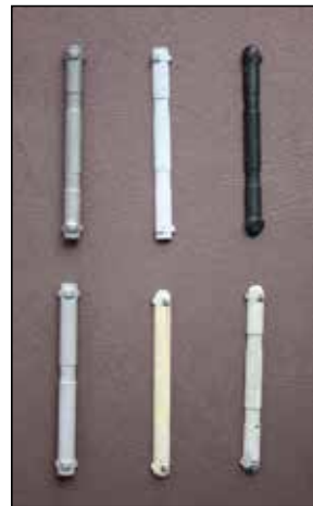
серое оксидное покрытие белое эмталиевое покрытие черное оксидное покрытие
