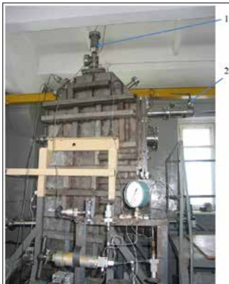
1 – газодинамический источник молекулярного пучка; 2 – механизм перемещения импульсного датчика давления
