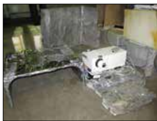
а) монохроматор МДР 204 и оптический спектрометр USB2000+ перед защитой
