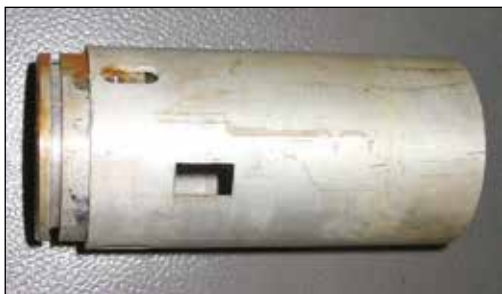
Рисунок 5.14. Корпус канала в месте расположения пружины прижима ТВС
