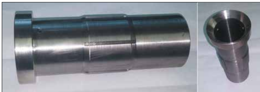
Рисунок 4.78. Общий вид регулятора расхода натрия
