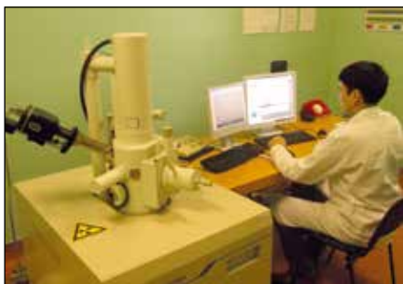
Рисунок 1.4. Растровый, сканирующий электронный микроскоп JSM-6390
