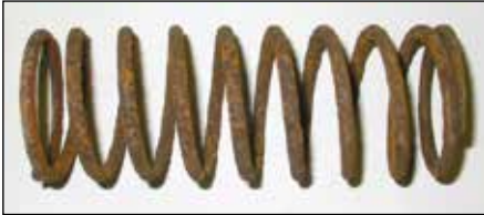
Рисунок 5.16. Пружина прижима ТВС после 14-летней эксплуатации в канале ВОТК
