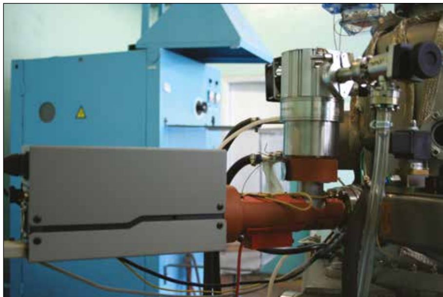
Рисунок 5.59. Внешний вид масс-спектрометра CIS-100
