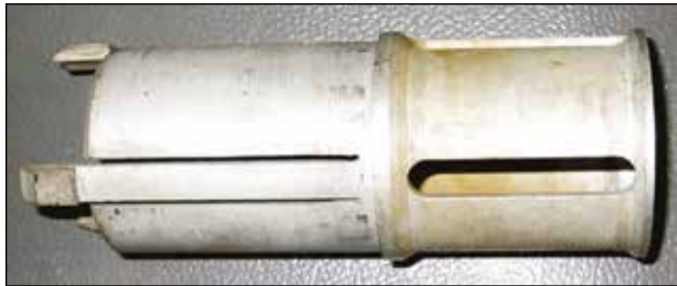
Рисунок 5.10. Фрагменты головки канала (вырезаны и отсутствуют на снимке фрагменты, содержащие сварные швы №1 и №2 пенала головки)
