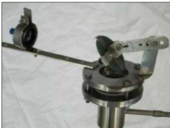
б) верхний фланец с механизмом юстировки зеркала и коллиматора
