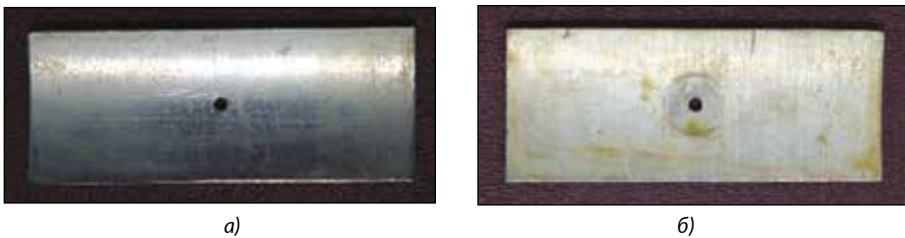
Рисунок 5.6. Внешний вид 12X18H10T-образца (а) и пассивированного (Al,Mg)-образца (б) после 22,9-летних испытаний в воде
