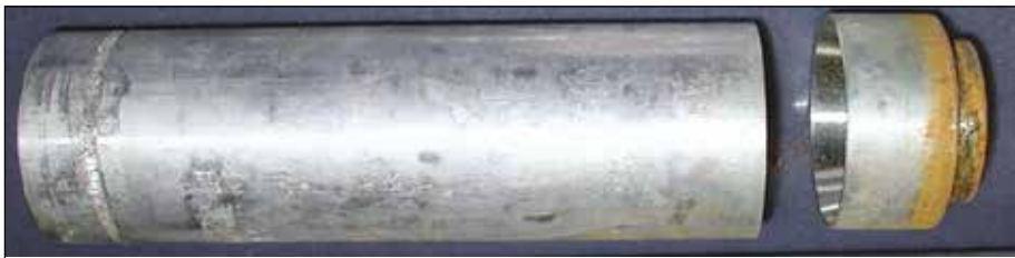
Рисунок 5.18. Нижние упорные втулки пружины прижима ТВС
