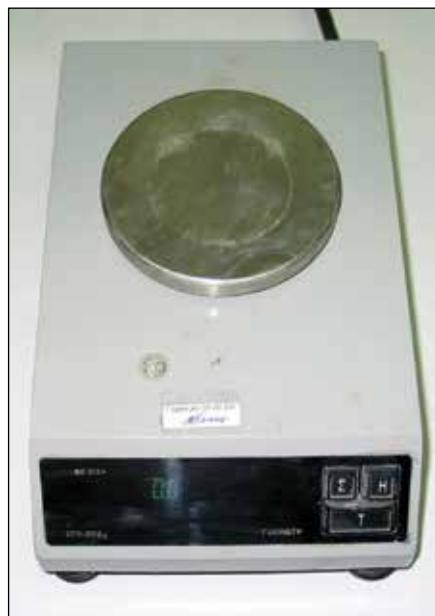
а) Лабораторные аналитические весы б) Электронные весы ВЛ Э134 «METTLER-TOLEDO» AG204 (0,1мг)
