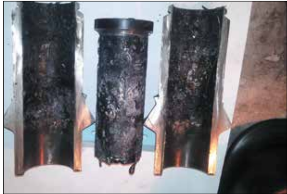
Рисунок 4.80. Вид разрезанной сливной трубы и извлеченного из нее регулятора расхода натрия
