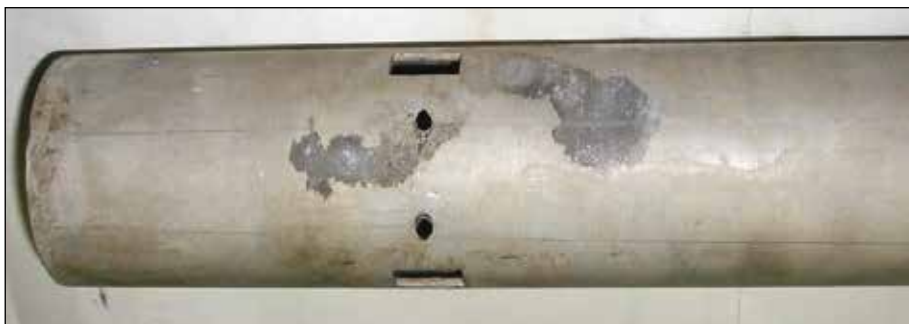
Рисунок 5.26. Нижняя часть канала после отстыковки хвостовика и абразивной обработки пятен
