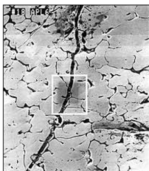
прослойка в трещине ( \times 600 )
