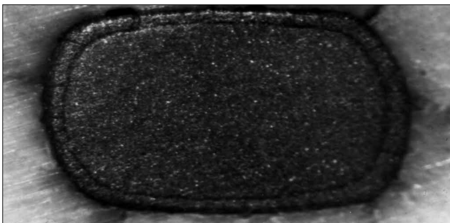
Рисунок 2.44. Поперечный шлиф твэла из (U,Zr)C - 30 с противоосколочным покрытием из ZrC+C после испытаний в азотной ресурсной модернизированной ампуле РА-М ( P = 0,45 МПа, \tau = 1050 ч, T_{обл} = 1520 К)
