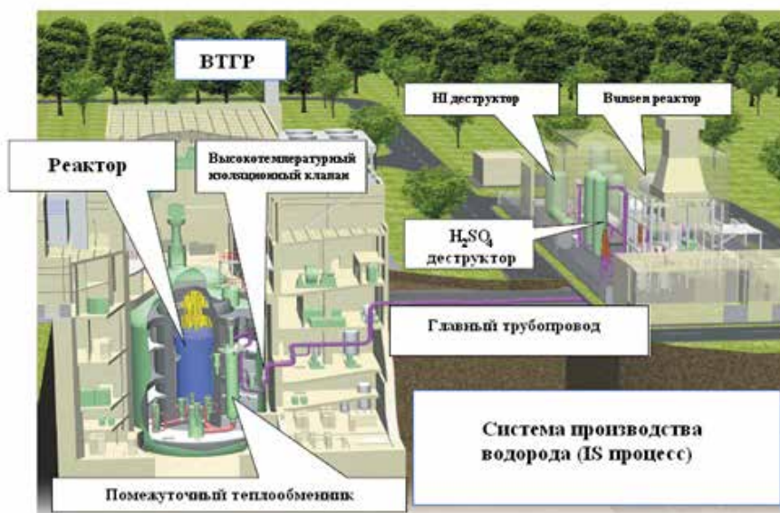
Рисунок 3.58. ВТГР с установкой для производства водорода
