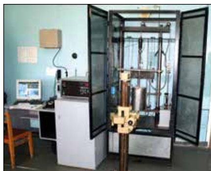
Рисунок 1.8. Экспериментальная установка для коррозионных испытаний под напряжением «КОРИНА»
