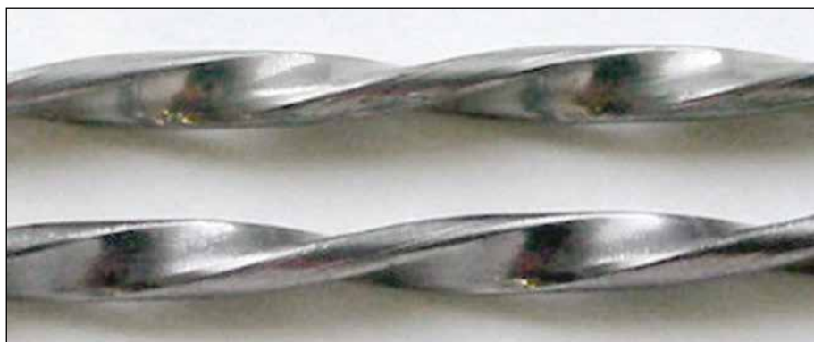
Рисунок 5.23. Твэлы до (вверху) и после (внизу) 14-летних испытаний в канале ВОТК №4
