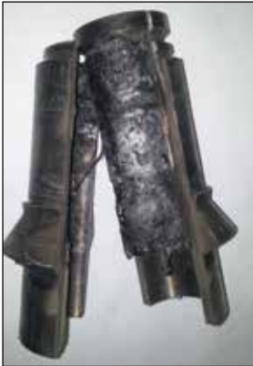
Рисунок 4.79. Состояние регулятора расхода натрия внутри сливной трубы
