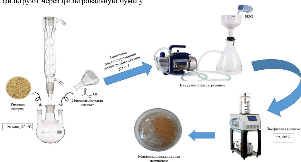
Рисунок 1. Схема получения микрокристаллической целлюлозы из рисовой шелухи
