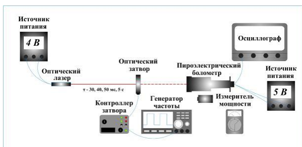
Рисунок 4. Принципиальная схема калибровки пирозлектрического болометра
