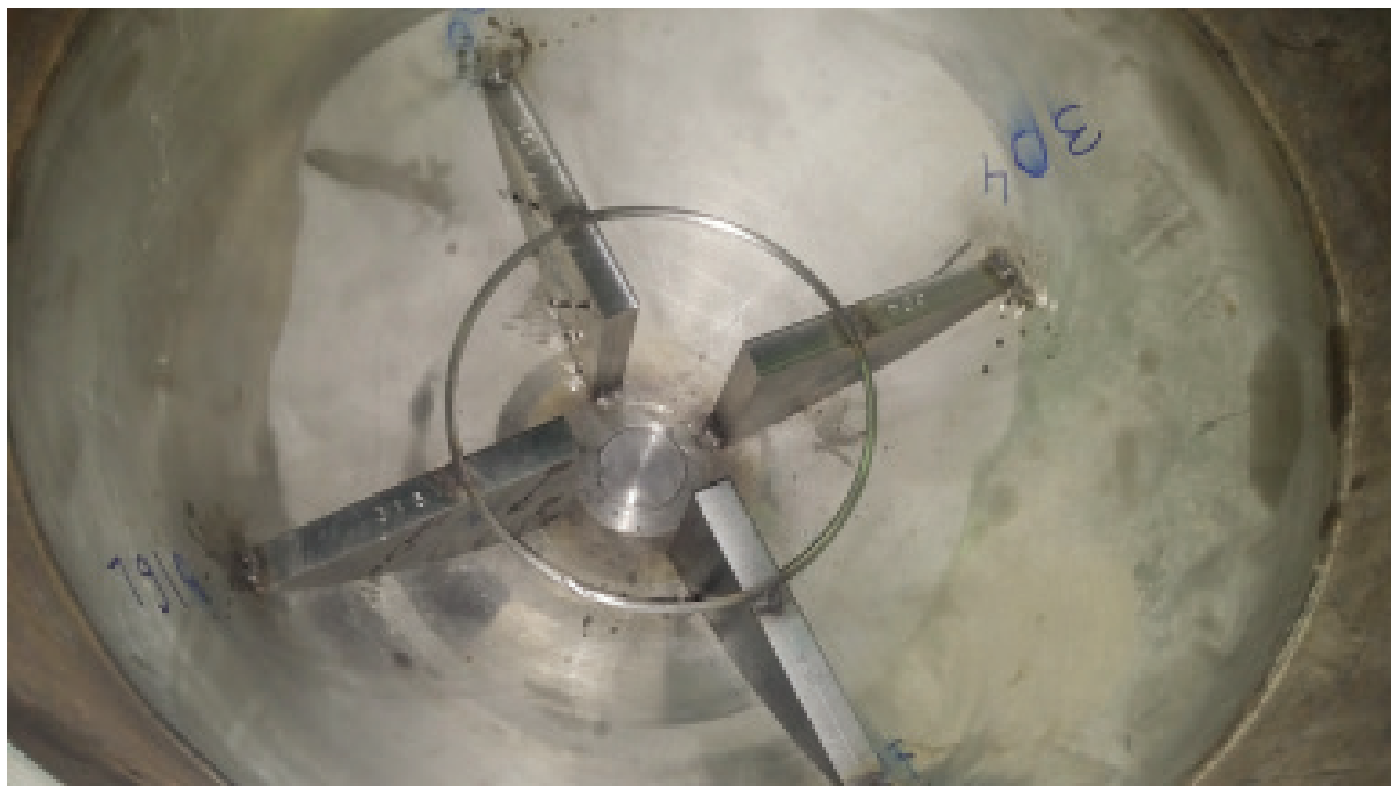
Ловушка расплава с установленными образцами реакторных конструкционных материалов
