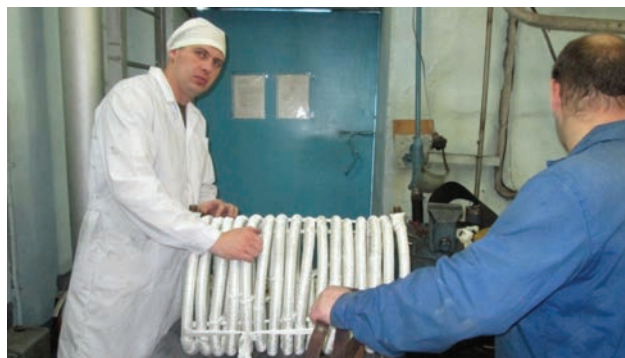
Подготовка индуктора ЭПП к работе
