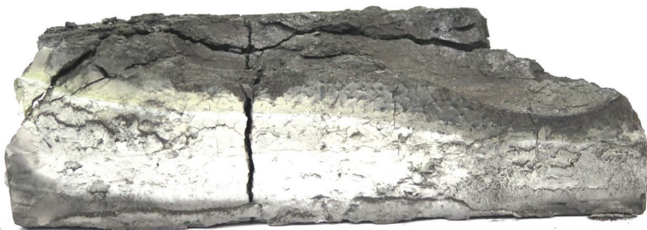
Внешний вид донного блока после эксперимента RT-11
