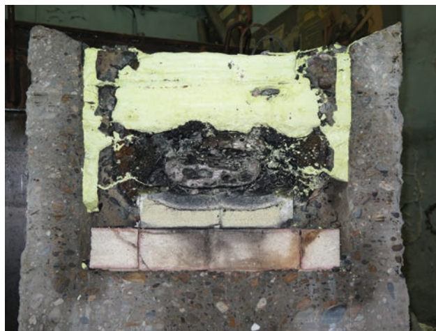
Ловушка с блоками до (внешний вид) и после (в разрезе) эксперимента RT-9/2
