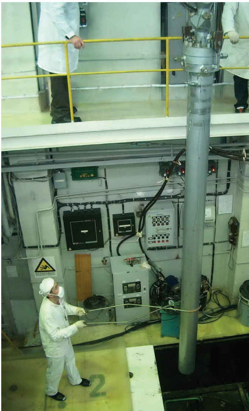
Загрузка экспериментального устройства в хранилище после проведения реакторного эксперимента, 2005
