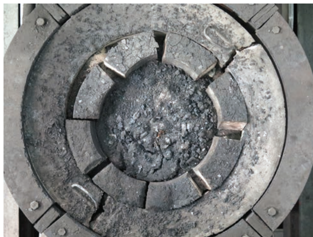
Ловушка с блоками до (внешний вид) и после (в разрезе) эксперимента RT-9/2
