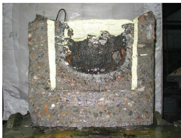
Внешний вид сечения ловушки после эксперимента RT-12
