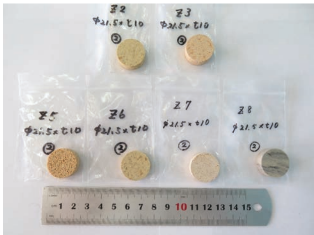
Внешний вид различных образцов огнеупорных блоков, подготовленные для маломасштабных экспериментов
